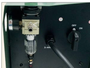
Schlag- und stoßgeschützter Druckminderer
