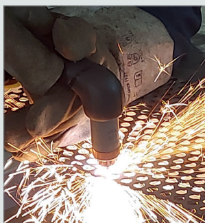
Lochblechschneiden ohne Unterbrechung
