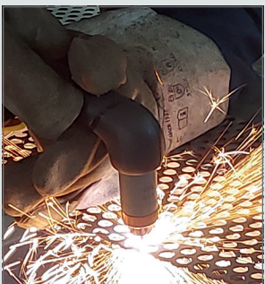
Lochblechschneiden ohne Unterbrechung
