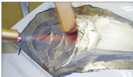
Modellieren des Füllmaterials
