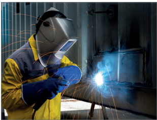
Reparaturschweißung am Container
