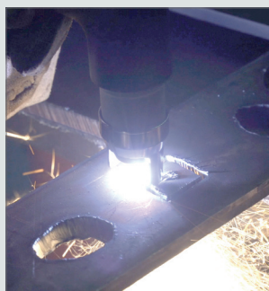
Durchstechen bis max. 10 mm
