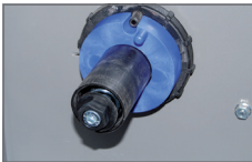
Adapter so aufstecken, dass der Mitnehmer des Spulendorns in der Nut des Adapters sitzt.
