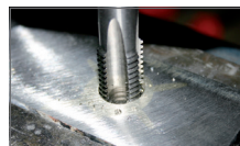
Neues Gewinde einschneiden
