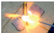
Reparaturstelle mit NSF 078 U löten
