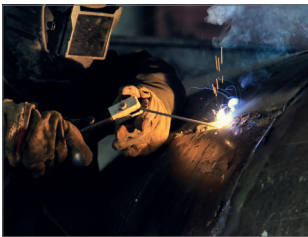
Reparaturschweißung am Behälter
